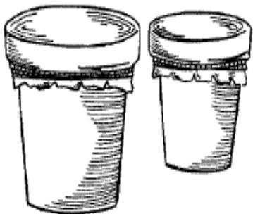
Κατασκευάζονται με μικρές γλάστρες (πήλινες ή πλαστικές) ή κυλινδρικά κουτιά στα οποία τεντώνουμε ένα ελαστικό υλικό (σαμπρέλα, κομμένο μπαλόνι, πλαστική ή δερμάτινη μεμβράνη) και το στηρίζουμε σφίγγοντας το στην περιφέρεια με ένα σπάγκο.
